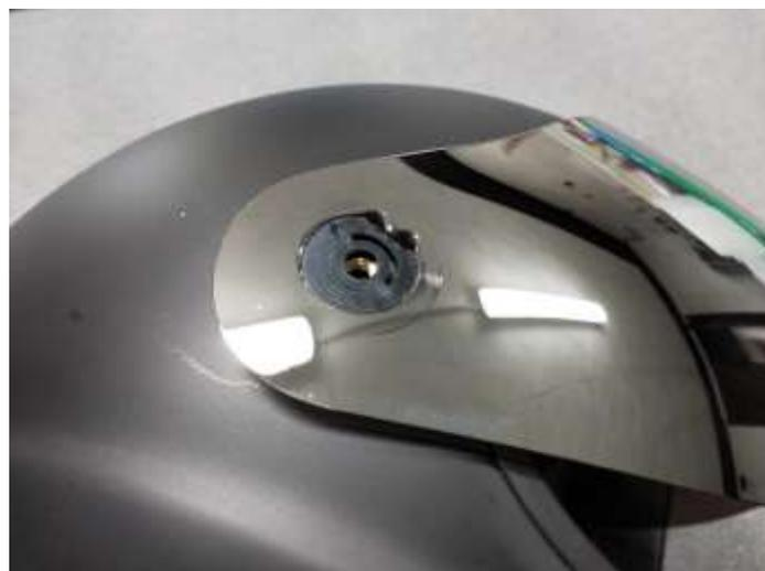
Insérer la grande vis en aluminium et la visser à l'aide d'un tournevis, en veillant à ne pas la serrer excessivement.
