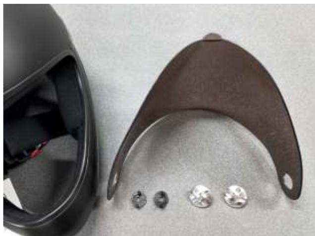
En retirant les autocollants, on découvre, de chaque côté de la coque extérieure, un trou avec une douille filetée, entre deux trous non filetés.
